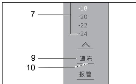
若一次性冷冻大量食品，应提前打开速冻功能，让冷冻室降至较低温度，再放入食品。
