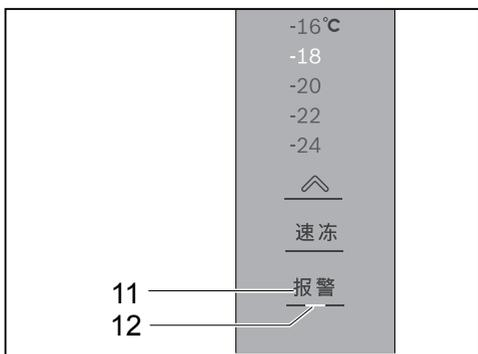
触摸报警按钮11, 关闭蜂鸣器的报警声。当箱内温度低于报警温度时,报警指示灯将自动熄灭。
